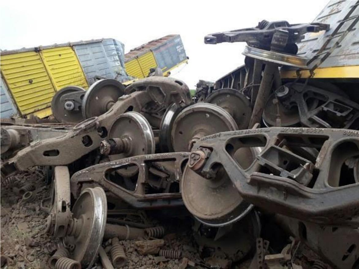
**A través de las fotos podemos inferir la falta de mantenimiento en la conservación del terraplénado, falta de balasto (piedras-balasto)**
